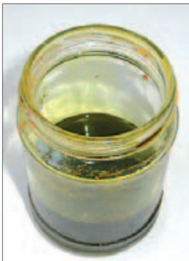
После многочисленных травок хлорное железо становится темно-коричневым
