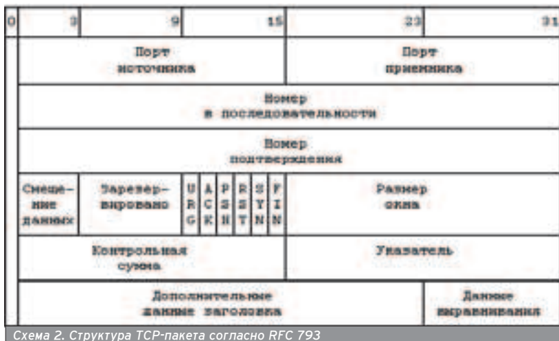
Схема 2. Структура TCP-пакета согласно RFC 793
