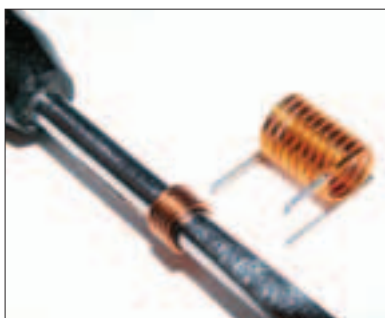
Мотаем катушку на оправе, для сравнения рядом катушка на 27 МГц
